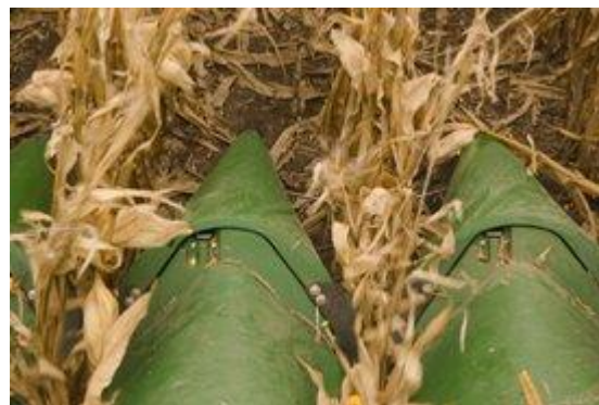
Механические сенсоры соединены с данными GPS для управления движением
