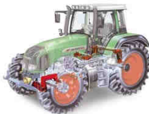
Амортизированное шасси трактора Fendt 900 Vario
